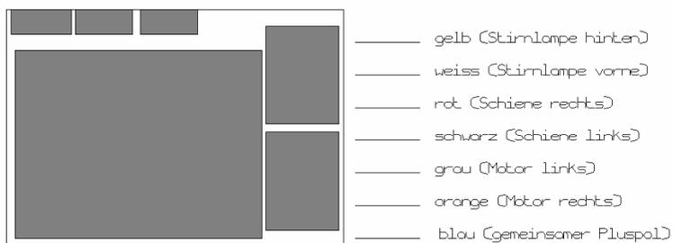
*Bild 2 Anschlussbelegung*
